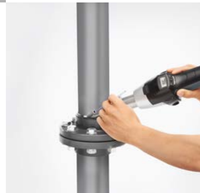
▼ Schweißen im Apparatebau HG 2620 E
