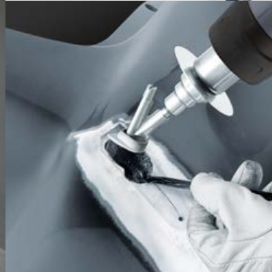
▲ Stoßfänger reparieren HG 2320 E
